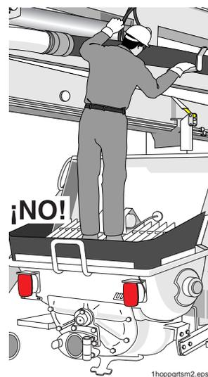
**4.13** Hay un solo operador de la bomba de concreto. El operador de la bomba es responsable de la operación segura de la bomba y de la pluma. Si tiene preguntas con respecto a los procedimientos seguros de bombeo, hable con el operador. Distintos operadores tienen distintos procedimientos, y esto no quiere decir necesariamente que uno de ellos esté equivocado. Si tiene dudas, pregunte.
