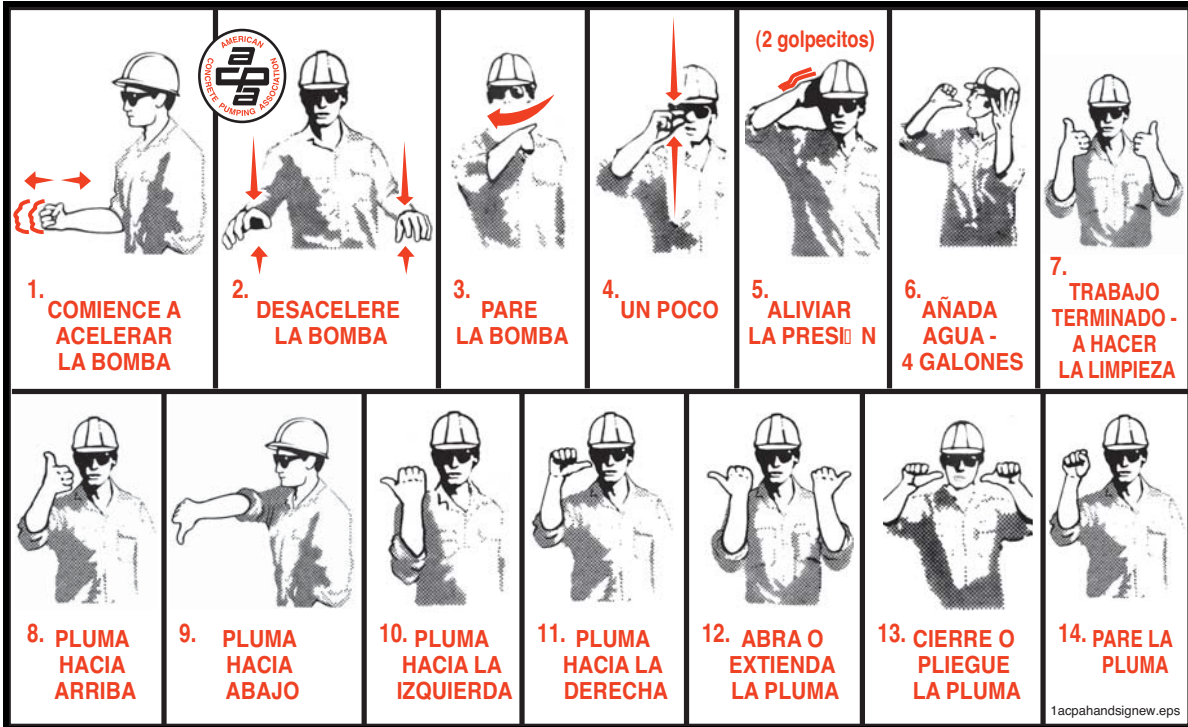
Figura 94 Señales de mano recomendadas por la ACPA (Asociación Americana de Bombeo de Concreto)
