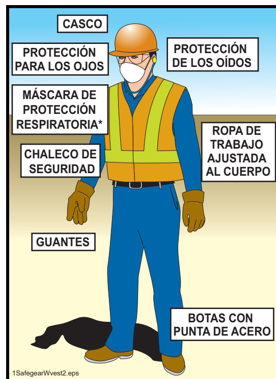
Figura 86 Use equipo personal de protección (P.P.E.)
